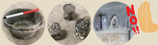
実際に焼却炉に詰まっていた不燃物
